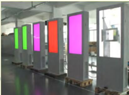
Essai de rayonnement solaire simulée ▶
